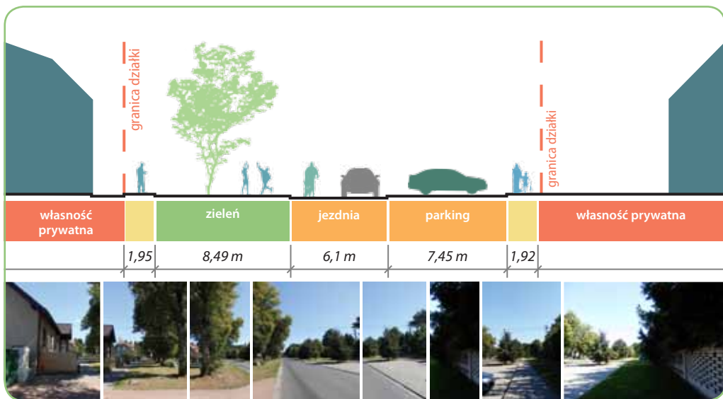
Rys. 30 przekrój przez ulicę Lipową w Wołczkowie (opracowanie własne RBGP WZ)
