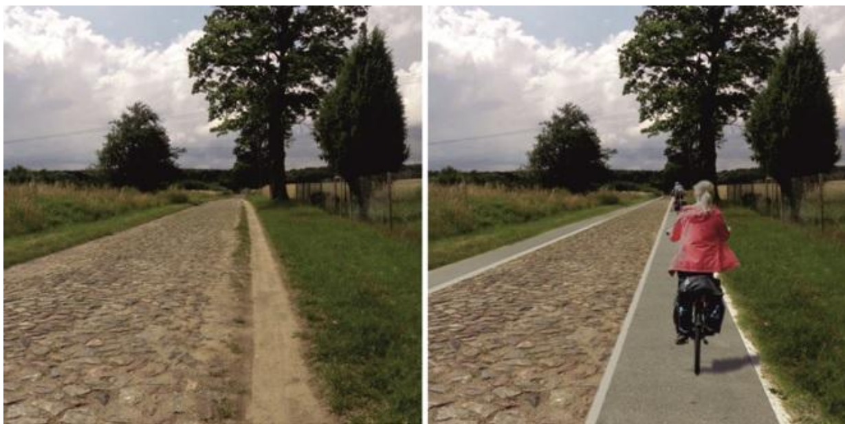
Ryc. 69 Przykładowa zmiana organizacji istniejącego układu drogowego - ciąg rowerowy przy drodze z brukowca (Typ 3b)
