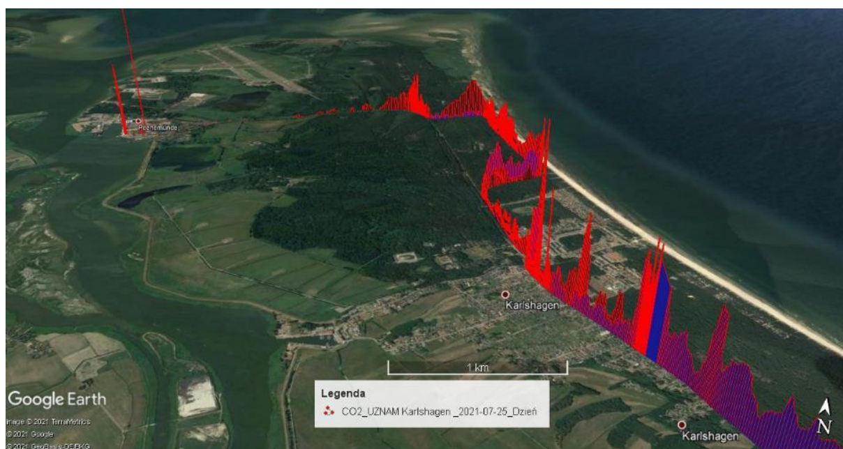
Rysunek 4.34. Wyspa Uznam (Karlsruhe) – stężenie CO 2 wzdłuż trasy przejazdu, pomiar dzienny (25-07-2021)
