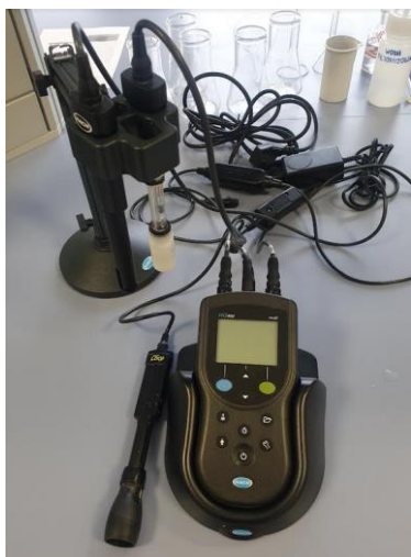
Rysunek 7.36. Badania polowe jakości wód – miernik HQ40d z sondą LDO do pomiaru zawartości tlenu oraz elektrody do pomiaru przewodnictwa i odczynu wody
