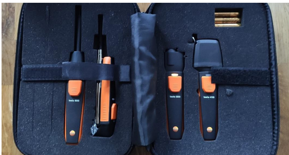
Rysunek 7.38. Badania polowe jakości wód – zestaw smart-sond Testo – do pomiaru parametrów klimatyzacji oraz powietrza zewnętrznego
