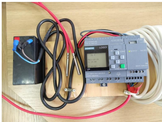
Rysunek 7.37. Badania polowe jakości wód – mobilny zestaw pomiarowy do dwukanałowego pomiaru temperatury wody i powietrza
