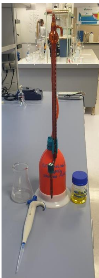
Rysunek 7.39. Badania laboratoryjne – stanowisko oznaczania chlorków metodą Mohra
